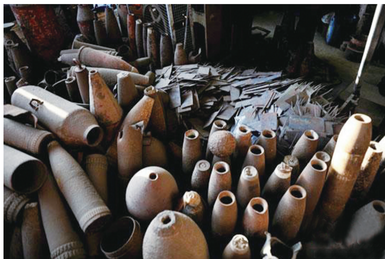
▲金门居民利用弹壳弹头制造金门菜刀(资料图)
