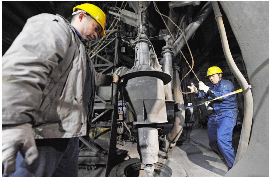
▲工作人员正在拔出基夫赛特炉的下料口喷嘴,此举意味着株冶在清水塘地区的最后一座冶炼炉熄火停产
